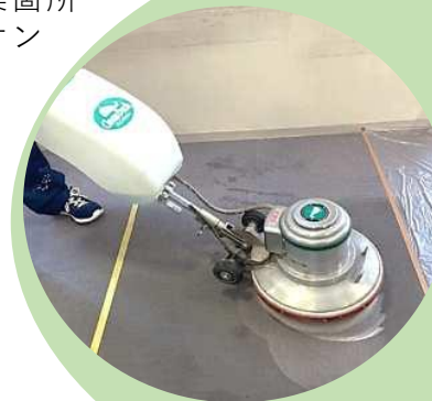
同質の床を区分に分けてパターン検証 ・洗剤 ・アルカリイオン電解水 ・中性洗剤+アルカリイオン電解水
